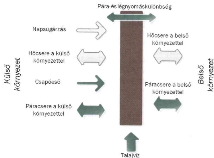
1. ábra: Határoló falszerkezetet érő hő- és nedvességátadások
