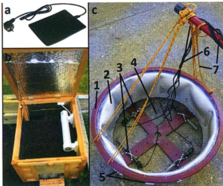
5. ábra: A lokális melegítés lehetséges eszközei: (a) fűtőpanel, (b) fűtőelemmel felszerelt szárazföldi búvóhely (Natassia Chacon fotója), (c) vízbe helyezhető készülék (1: meleg víz kiáramlását megakadályozó oldalfal, 2: hőszigetelés, 3: fűtőelemek, 4: ebihalak bejutását lehetővé tevő rés, 5: úszók, 6: elektromos kábelek, 7: készülék vízbe helyezését segítő felfüggesztés). (Az ábra eredeti közlése: Hettyey és mtsai. 2019)
