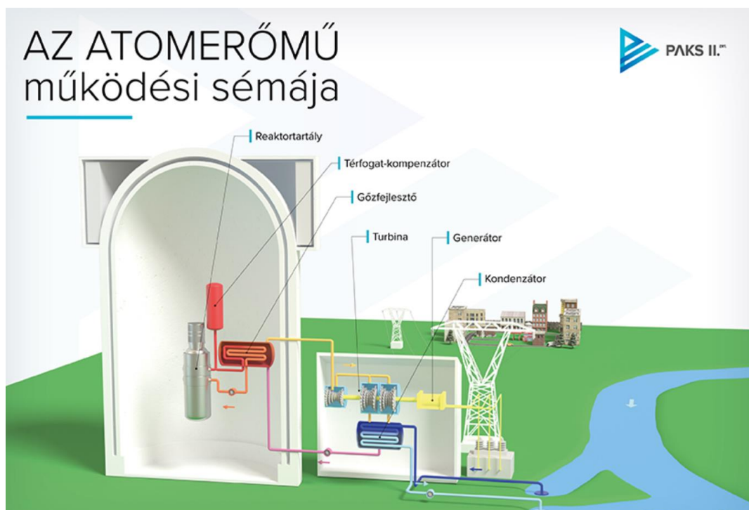
4. ábra Paks 2 atomerőmű működési séma
