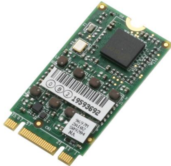
5. ábra. Aaeon M2AI-2242-520 kártya a Kneron KL520 chippel, 0.3 TOPS 44 számítási kapacitással, fél watt teljesítményfelvétel mellett
