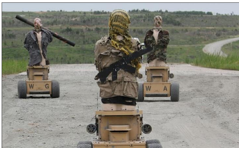
3. ábra. Az ausztrál Marathon Targets által éleslövészei kiképzésre fejlesztett autonóm és távolról vezérelhető robotcéljai 11
