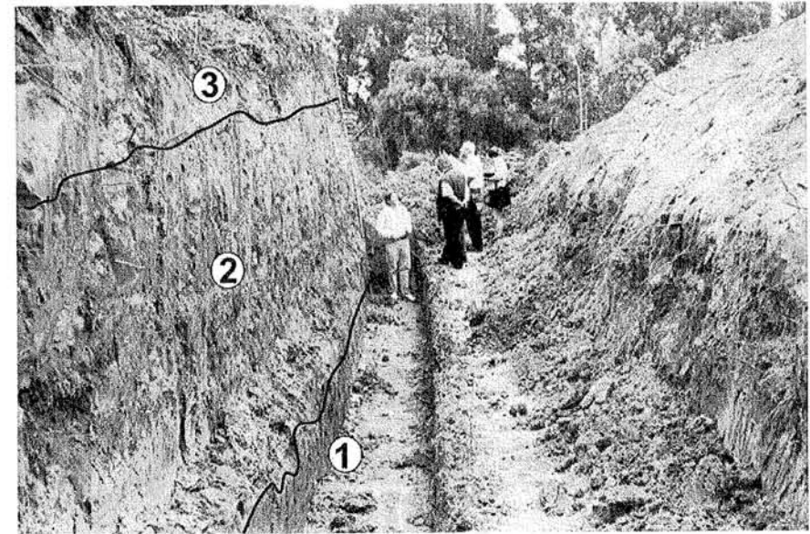
1. kép: A 2000. évi tiszai árvíz után a Szolnok melletti Alcsi-szigeten a hullámtéren a feliszapolódás mértékének vizsgálatára céljából mélyített kutatóárok szelvénye. A hullámtéri átvágásban megfigyelhető a folyó ármentesítés előtti felszínére (1) települt, itt megjelenő 200–230 cm vastag feltöltődés anyaga (2). A feltárás legfelső 30–35 cm-es része (3) az 1986-os csernobili katasztrófa óta halmozódott fel. Fotó: Schweitzer F.
