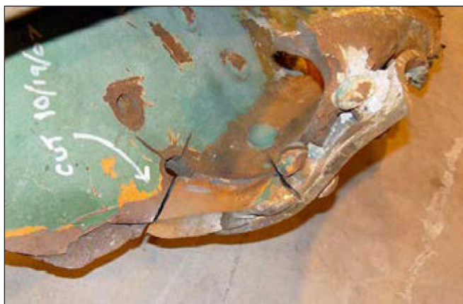
8. ábra: Egy csomólemezt a fáradási repedésekkel (internet)
