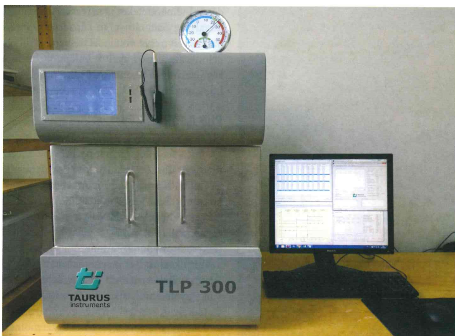
1. kép. Segédfűtőlapos peremvédett hővezetési tényező-mérő berendezés
