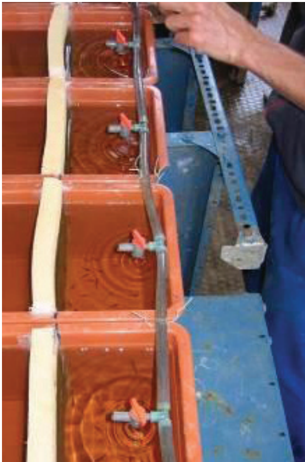
18. ábra: Etetésgyakorlási kísérlethez használt recirkulációs rendszer tartókádjai. A halak telepítési sűrűsége beragasztott szivacsapokkal növelve (MT).
