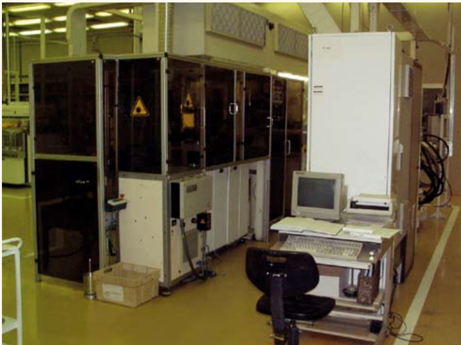
MK1 MONOLINER, a III. generációs, teljesen automata CD-gyártósor
