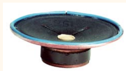
Lapos, táskarádió-hangszóró BaFe mágneskörrel
