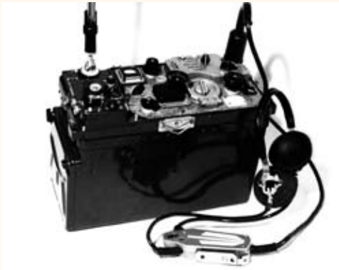
Az R-107 katonai adóvevő hordozható változata
