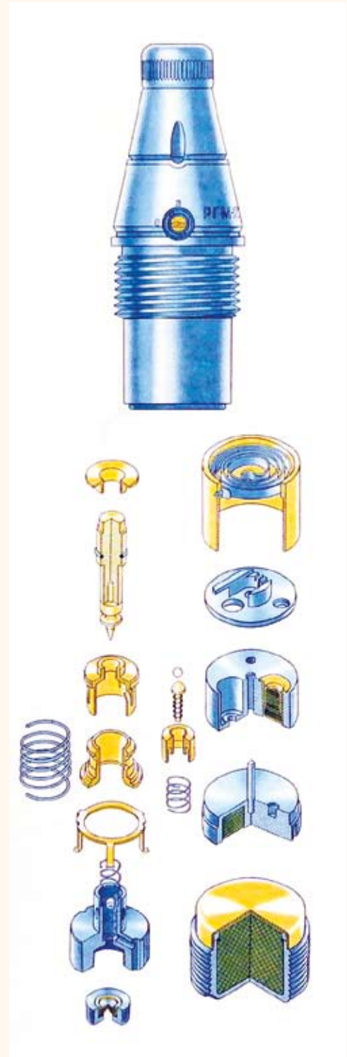
RGM-2 aknavető gyújtó alkatrészei
