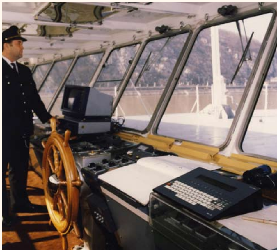
R11R-alapú navigációs rendszer geofizikai kutatóhajón
