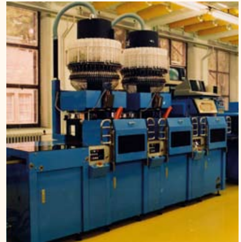
Elektromos alkatrész-beültető automata
