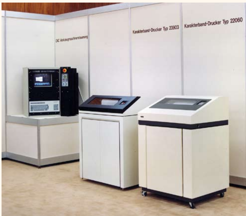
A VT 23000 és 22000 típusú karakterszalagos nyomtatók
