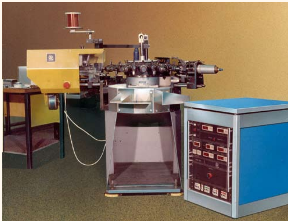
Nyolcfejes hangszórólengőterekercs-csévélő berendezés
