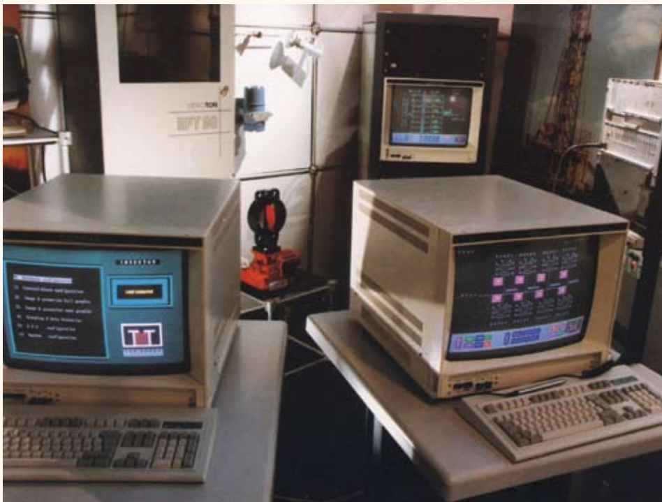
RPT 90 rendszer SCADA munkaállomásokkal
