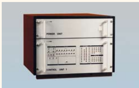
Control Unit, a sornymotatók ESZR/IBM rendszer-csatolója
