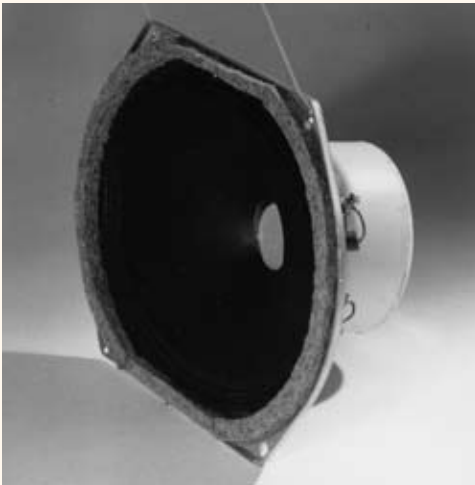
Ovális, kis szórt mágneserű hangszóró színes tévékhez
