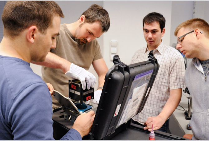
A MASAT-1 behelyezése a rázópadba
