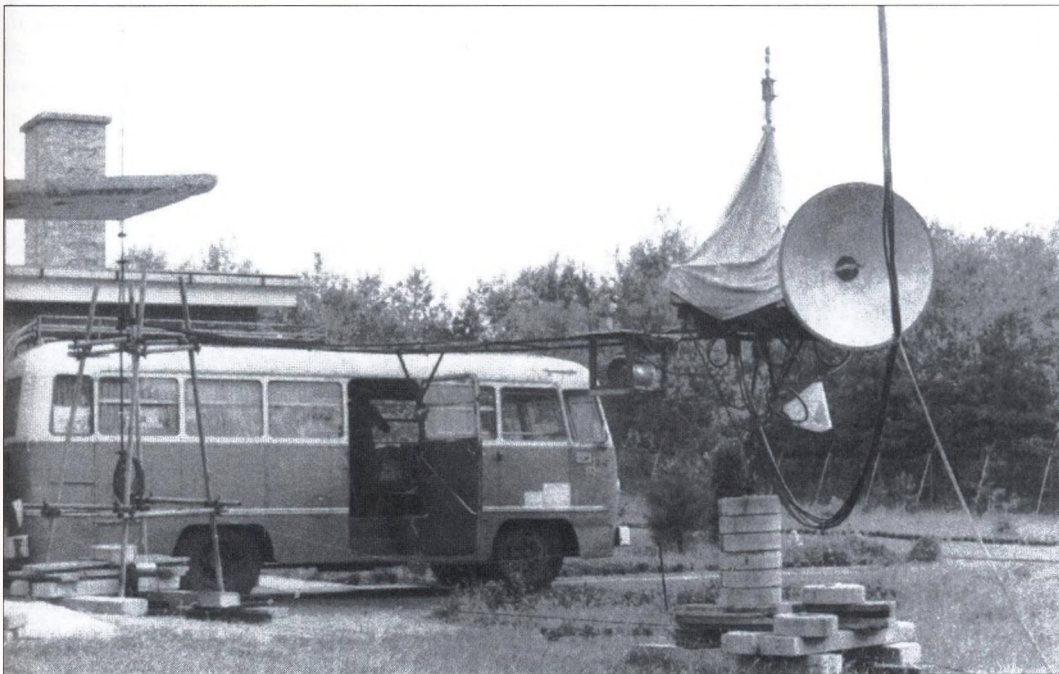
A műholdas összeköttetések antennáinak mérése. Fent: a PKI udvarán, alsó képen: Taliándörögd mellett a domboldalon
