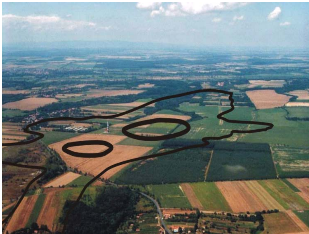
8. ábra: A hegyhátsági eddy-kovariancia mérőrendszer térbeli reprezentativitása az FSAM modell alapján. A vastagabb fekete görbék a mért jelhez leggyakrabban hozzájáruló területet jelölik, míg a vékonyabb vonal a teljes területet jelzi. (A légifotót Simon Martin készítette)
