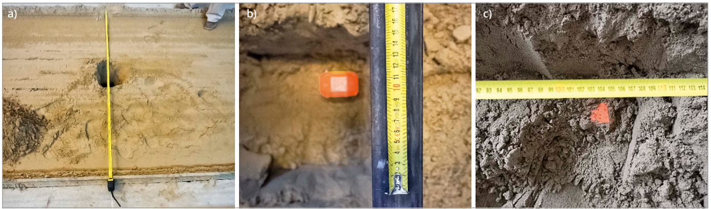
5. ábra A mérőeszköz elhelyezkedése a talajvályúban (a) a mérés megkezdése előtt (b), illetve a mérés után (c)
