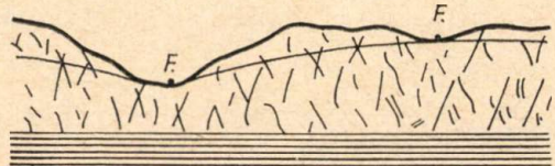
2. ábra. A talajvíztükrő helyzete repedezett, tömött kőzetekben
