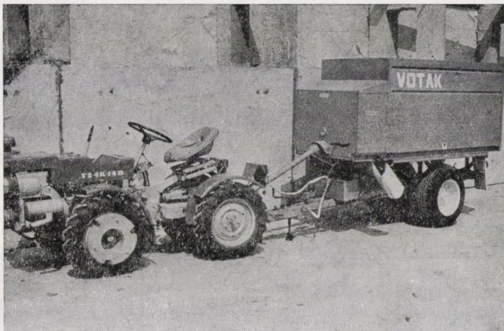
8. kép. VOTAK típusú, kis traktorvontatású, nyirkos takarmánykiosztó (MEFI)
