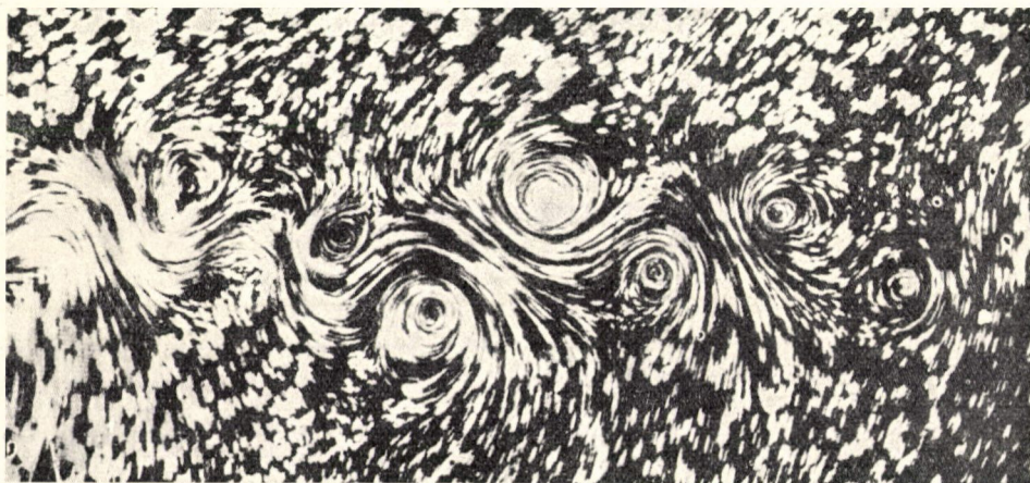
4. ábra. Kifejlődött Kármán-féle leváló örvénysor áramlási képe
