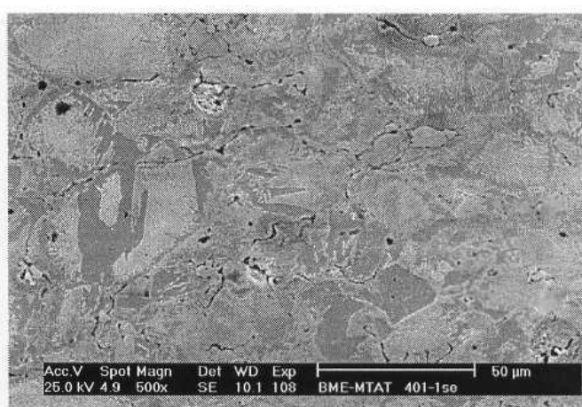
2.ábra Fe-C-Mo minta szekunder elektronokból formált SEM képe
