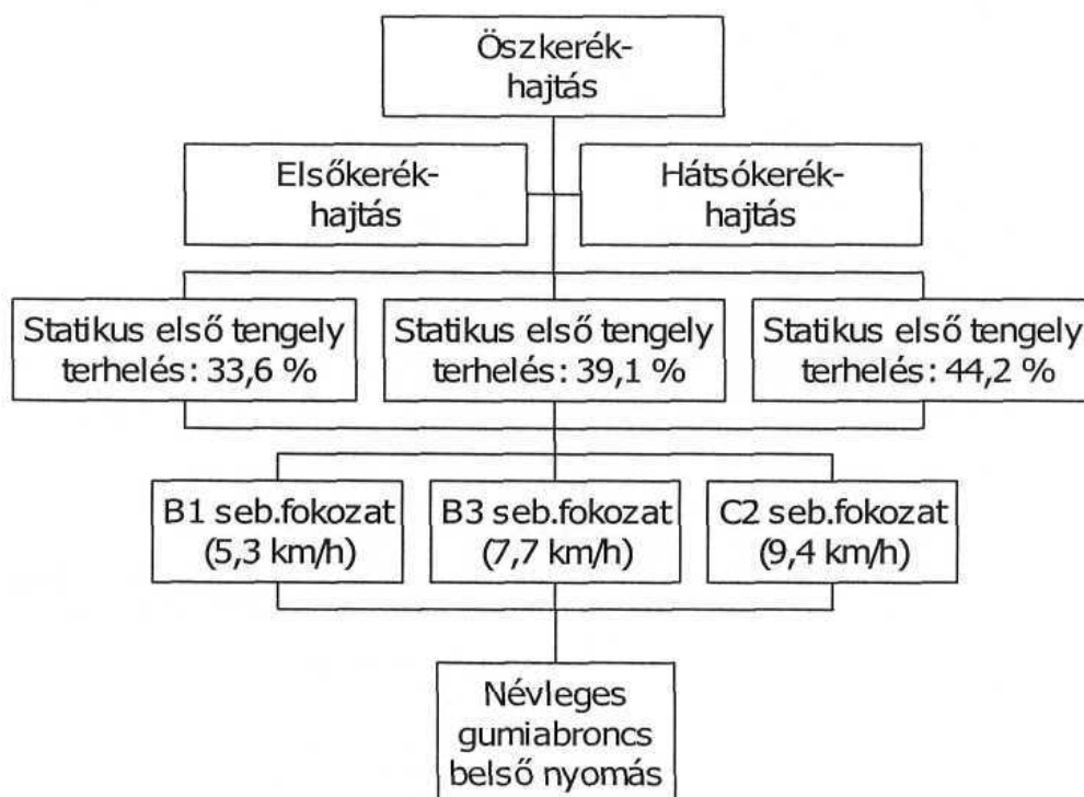
1. ábra. A traktor beállításai a vontatási vizsgálatokhoz
