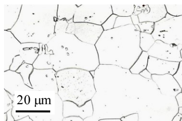
4. ábra Jellemző szövetszerkezet hideghengerezelt lemezeknél (1 mm-es szalag közepe)
