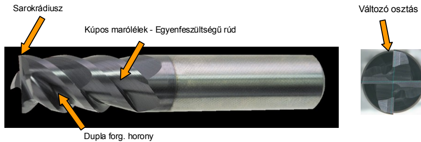
4. Ábra. Bonyolult élgeometriájú szármaró HSC-HPC megmunkálásra.
