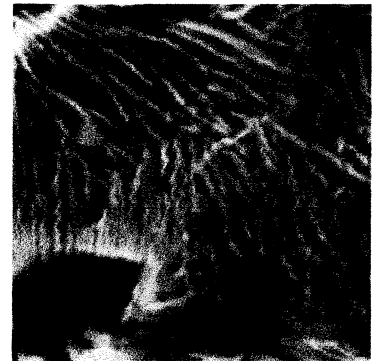
7. ábra. A C45 jelű anyag 620 °C-on keletkezett perlitje
