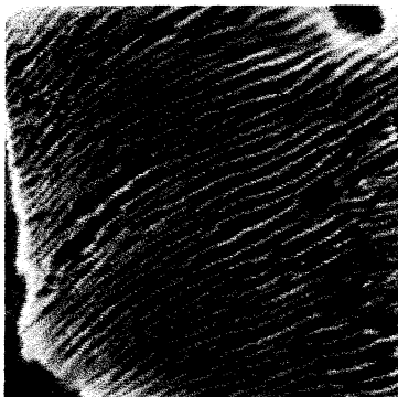
8. ábra. A C45 jelű anyag 530 °C-on keletkezett perlitje
