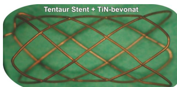
12. ábra. A Tentaur sztent titán-nitrid bevonattal készült változata (2002)
