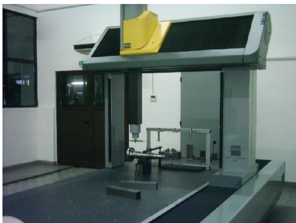
10. ábra. Az UNIO gyár tulajdonában lévő CNC fogaskerékellenőrző központ
