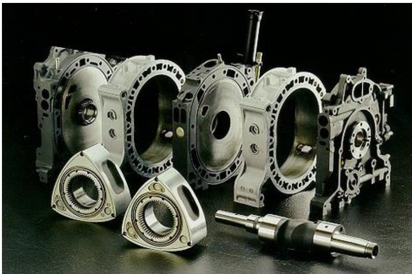
2. ábra. Kétdugattyús Wankel-motor fontosabb alkatrészei (forrás: internet)
