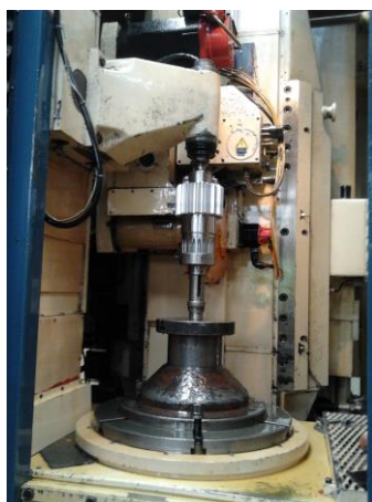
4. ábra. A FANUC vezérléssel felújított fogköszörűgép munkatere
