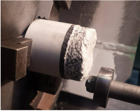
3. ábra. „Koszolódás” és a köszörült felület fémhab szerszámmal végzett köszörülés után
