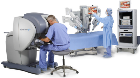
1. ábra. Master-slave üzemmódban működő da Vinci sebészeti robot [4]
