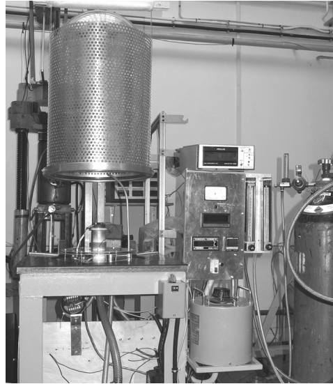
1. ábra. A saját építésű plazmanitridáló berendezés
