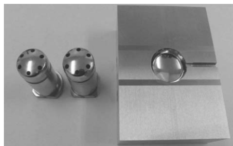
4. ábra. Fröccsöntő szerszám ultraprecíz megmunkálása ultrahangos rezgésekkel [3]
