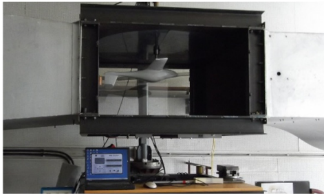
3. ábra. A repülőmodellel a szélcsatorna zárt kísérleti fülkéjében
