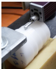
2. ábra. Poliamid felületének édesség mérése
