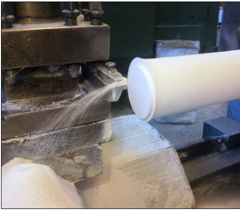
3. ábra. A kerámia előgyártmány esztergálása
