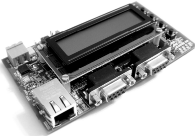
1. ábra. A saját fejlesztésű beágyazott mikrovezérlős osztott rendszer.
