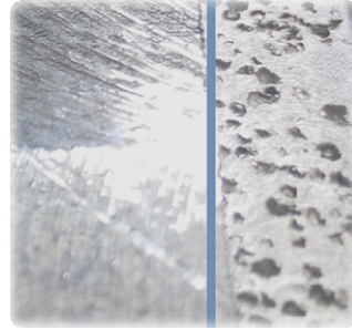
7. ábra. A 6061 (8AlO6Mg), 0,9 g/cm 3 sűrűségű ALUHAB® felülete konvencionális (balra) és ultrahangos (jobbra) marás után
