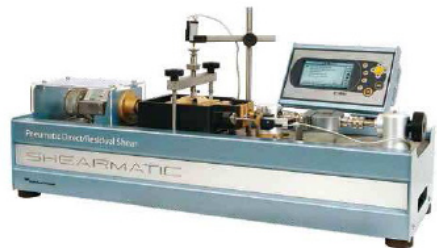
1. ábra. A közvetlen nyírókísérlethez használt berendezés
