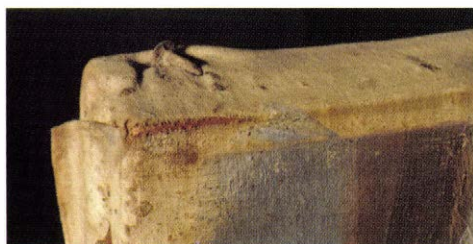
4. kép. A vászon a hajtások mellett több helyen elfoszlott, elhasadt.
