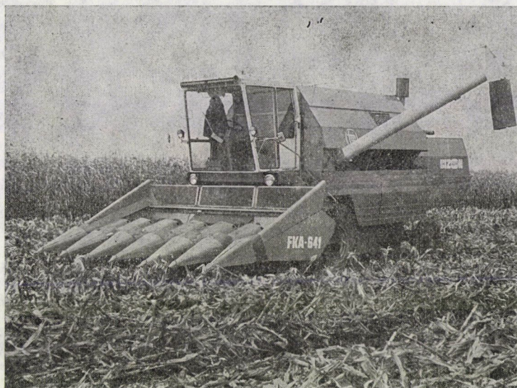
11. ábra. BIZON GIGANT nagyteljesítményű lengyel arató-cséplő gép magyar gyártmányú 6-soros FKA-641 típusú csőtörő adapterrel
