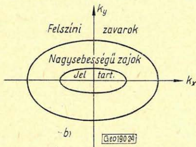
Fig. 24. Signale und Geräusche (a) im dreidimensionalen f, k_x, k_y Frequenzraum, (b) auf der Fläche f = f_0 . (nach Burg)
