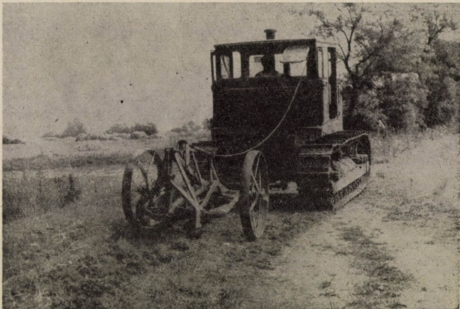
2. ábra. CE csatornanyitó ekére szerelt mély lazítókés
