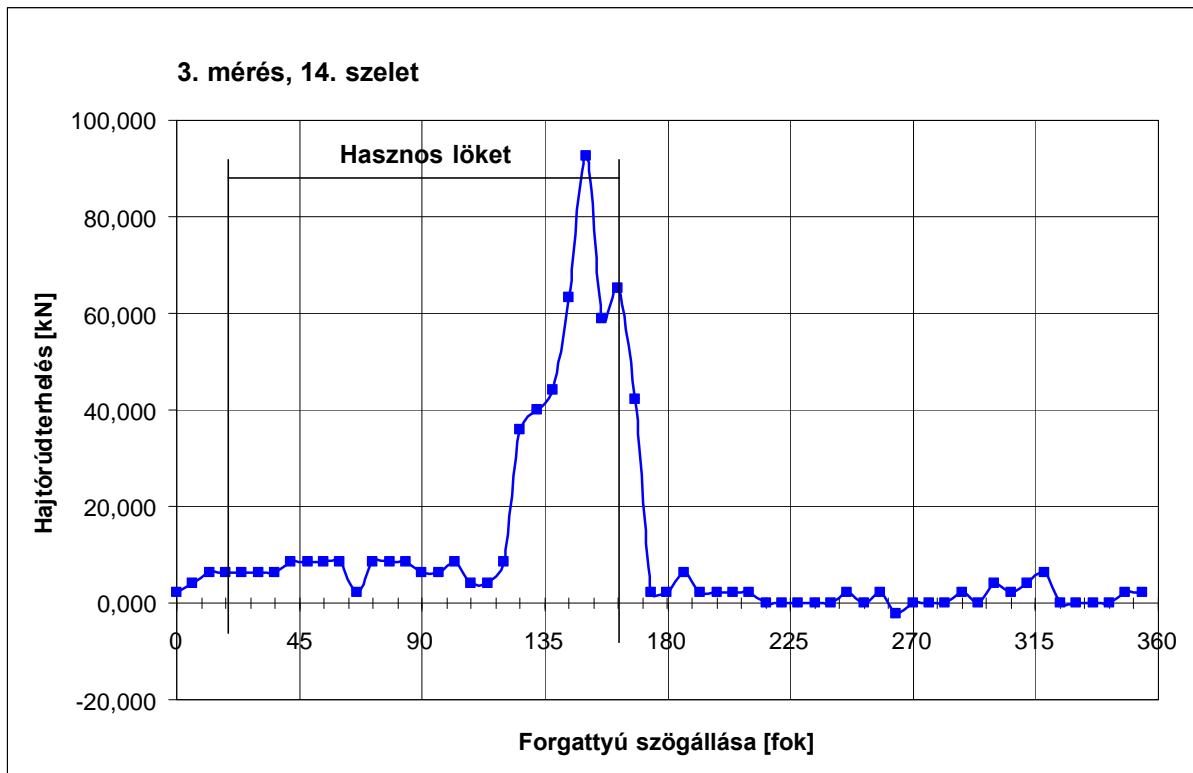
5. ábra: A hajtórúdterhelés változása a szögelfordulás függvényében
