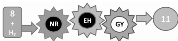
5. Ábra. (E)-2-Fenil-3-(2-nitrofenil)propénsav (8) származékok enantioszelektív kaszkád reakciójának ábrázolása, ahol NR: nitro csoport redukció, EH: enantioszelektív hidrogénezés és GY: gyűrűzárás; fekete alapon a Pd felületen lejátszódó lépések.
