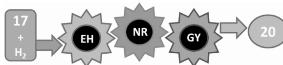
9. Ábra. 2-Nitrofenilpiroszölősav észterek ( 17 ) enantioszelektív kaszkád reakciójának ábrázolása, ahol EH : enantioszelektív hidrogénezés, NR : nitro redukció és GY : gyűrűzárás; fekete alapon a Pt felületen lejátszódó lépések.
