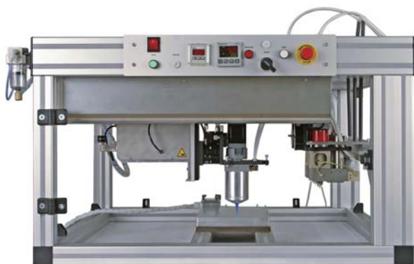
4. ábra. BioScaffolder mikroextrúziós berendezés
