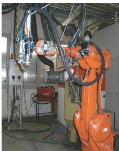
1. ábra: A lézerfejet mozgató robot
