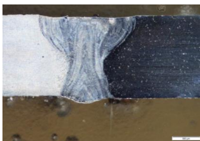
4. ábra: Lézersugaras hegesztéssel készült varrat
