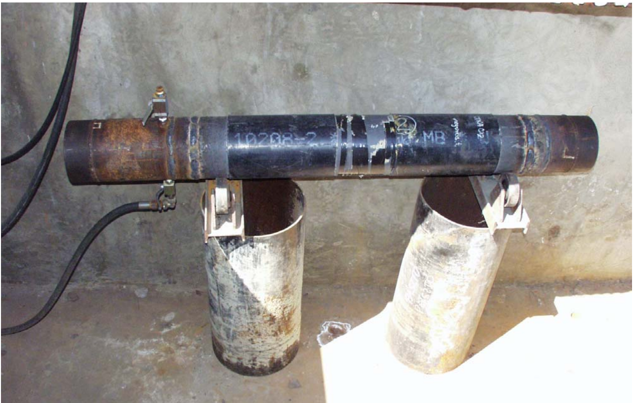
47. ábra. A belülről megerősített DN 200-as csőszakasz ( o2 ) a fárasztóvizsgálat után, repesztővizsgálatra előkészítve.
