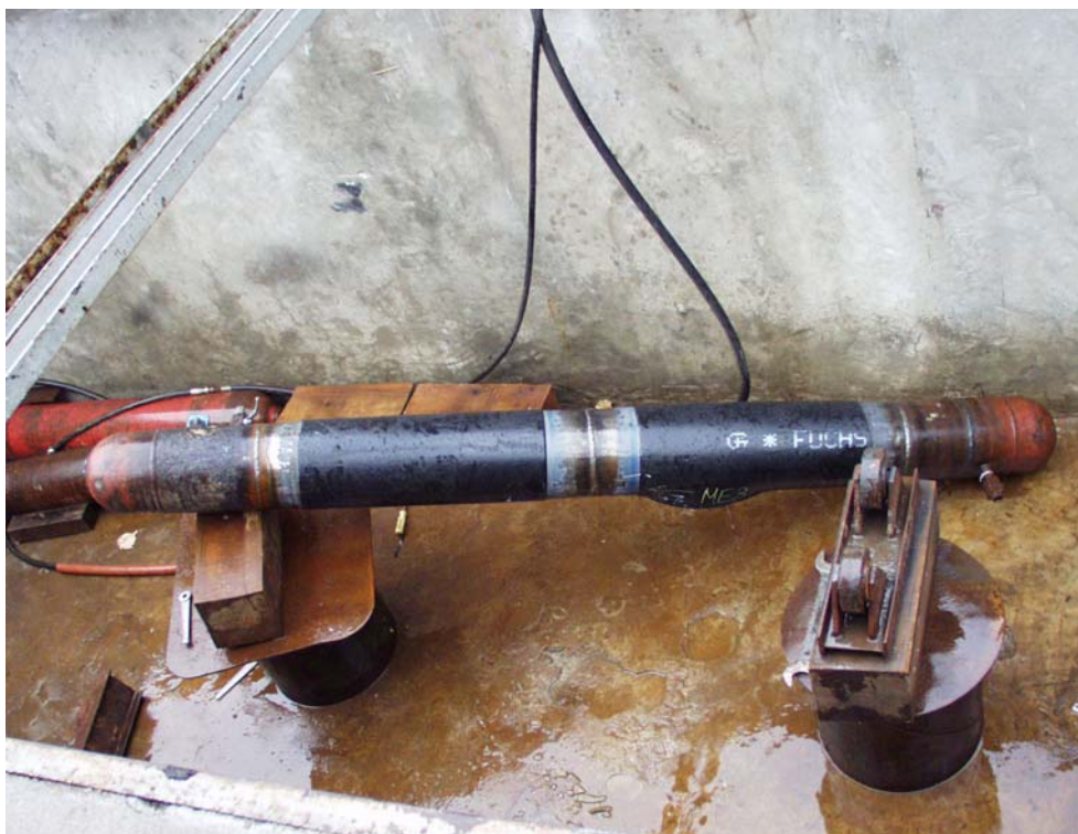
25. ábra. A megerősítés nélküli, egy körvarratot tartalmazó, DN 200-as csőszakasz (a4) a repesztővizsgálat után.
