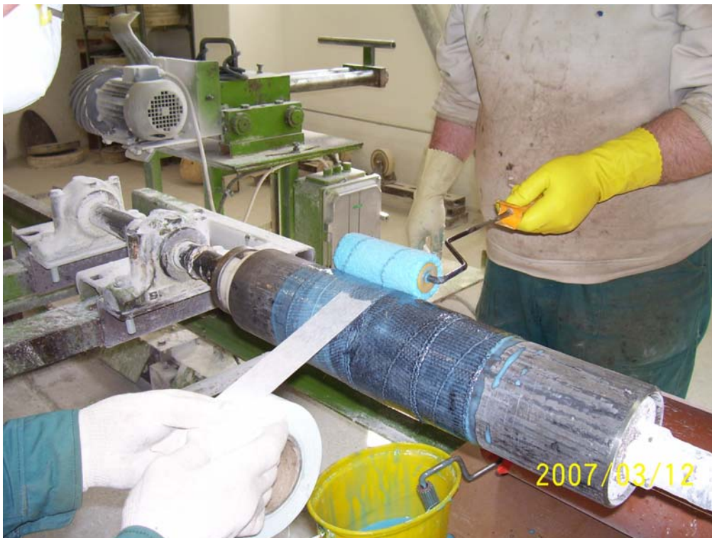
6. ábra. Egy DN 100-as csőszál külső megerősítése: a fátyol bevonat felvitele.
