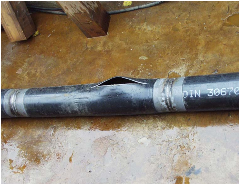
22. ábra. A megerősítés nélküli, két körvarratot tartalmazó, DN 200-as csőszakasz (a3) a repesztővizsgálat után.
