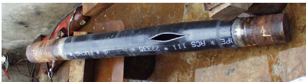
28. ábra. A megerősítés nélküli, hibátlan, DN 200-as csőszakasz ( b1 ) a repesztővizsgálat után.
