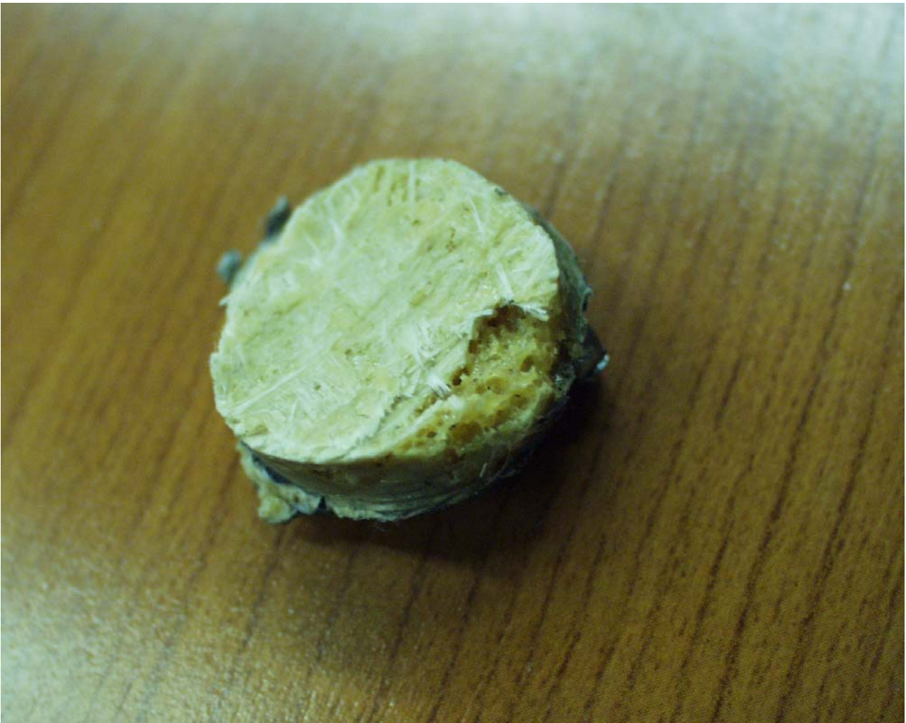
50. ábra. A teljes károsodás helyéről kilökött belső megerősítés darab a belülről megerősített, mesterséges hibákat tartalmazó, DN 200-as csőszakaszról (o2).
