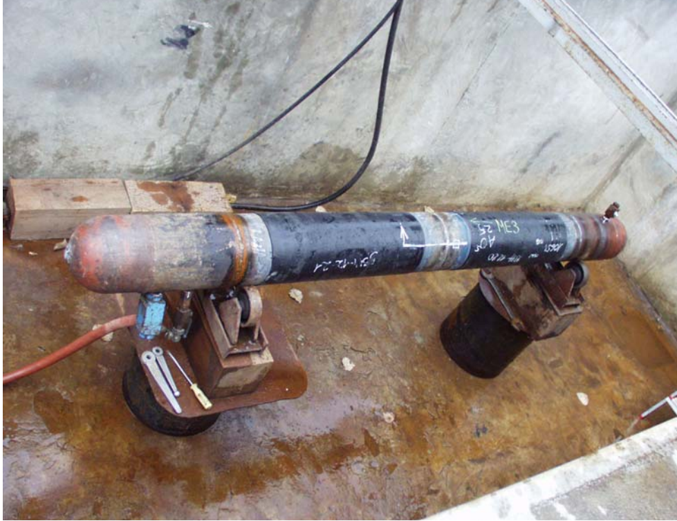
24. ábra. A megerősítés nélküli, egy körvarratot tartalmazó, DN 200 -as csőszakasz (a4) a fárasztóvizsgálat után, repesztővizsgálatra előkészítve.
