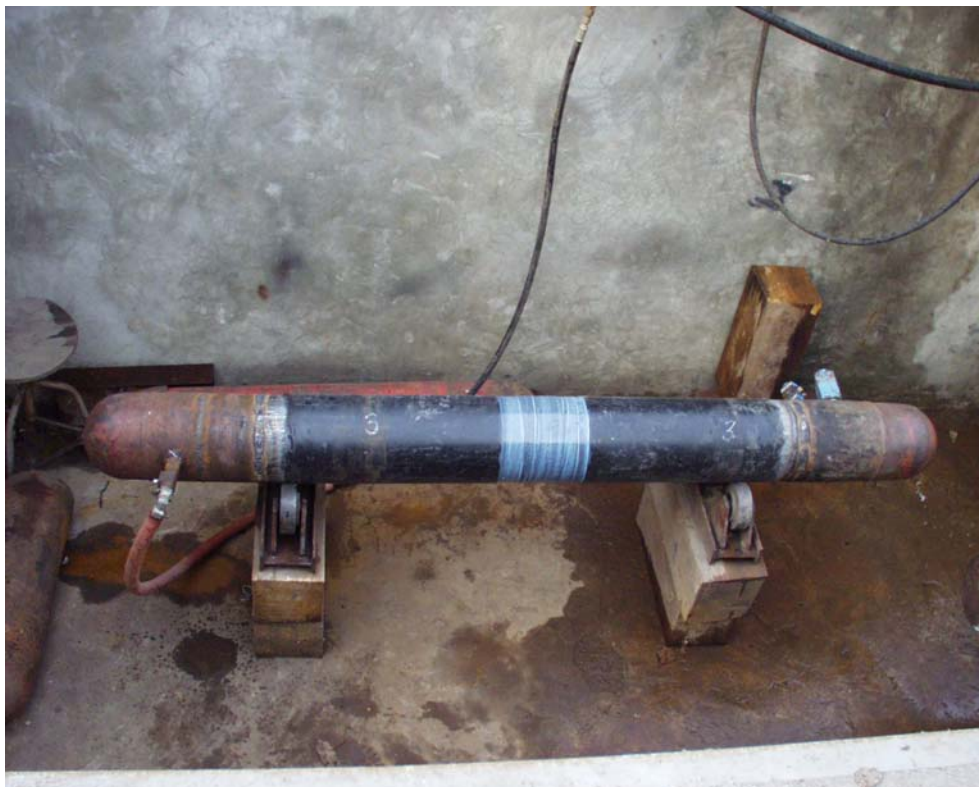
30. ábra. A kívülről megerősített DN 200-as csőszakasz (b3) a fárasztóvizsgálat után, repesztővizsgálatra előkészítve.
