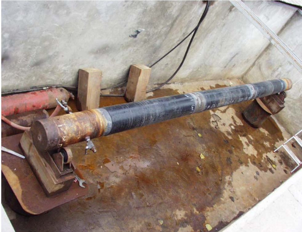
21. ábra. A megerősítés nélküli, két körvarratot tartalmazó, DN 200-as csőszakasz (a3) a fárasztóvizsgálat után, repesztővizsgálatra előkészítve.
