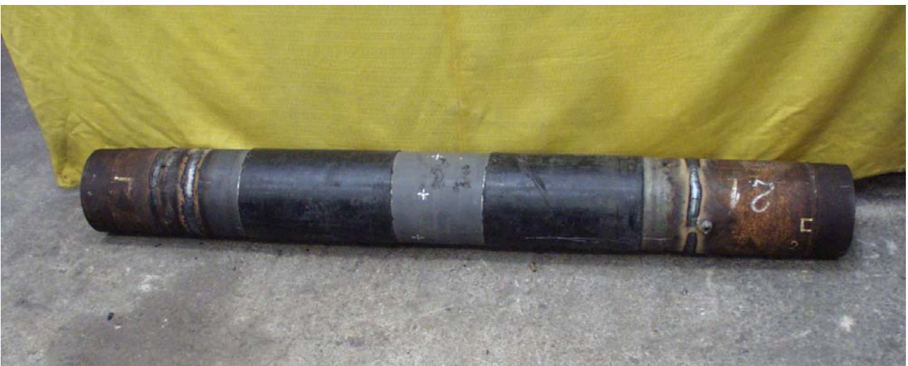
45. ábra. A belülről megerősített, mesterséges hibákat tartalmazó, DN 200-as csőszakasz (o3).
