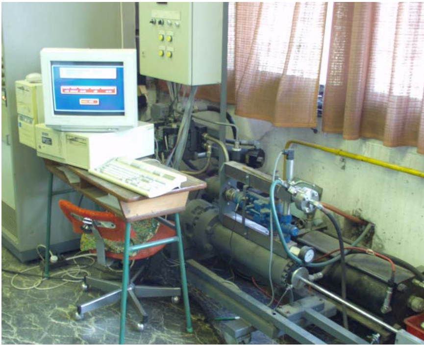
18. ábra. A fárasztó- és repesztő-rendszerek munkahengerei, a vezérlő- és adatgyűjtő számítógépekkel.
