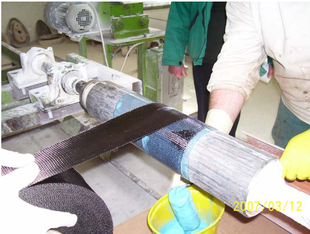
4. ábra. Egy DN 100-as csőszál külső megerősítése: karbon szövettel történő tekerés a körvarrat egyik oldalán, folyamatos gyanta felhordás mellett.
