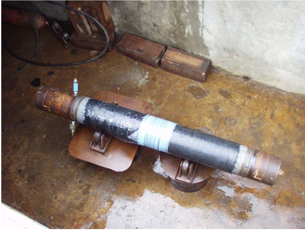
37. ábra. A kívülről megerősített DN 200-as csőszakasz (b5) a fárasztóvizsgálat után, repesztővizsgálatra előkészítve.
