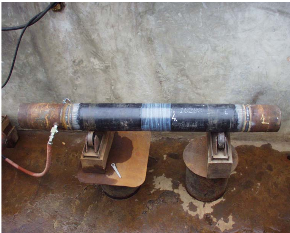
34. ábra. A kívülről megerősített DN 200 -as csőszakasz ( b4 ) a fárasztóvizsgálat után, repesztővizsgálatra előkészítve.
