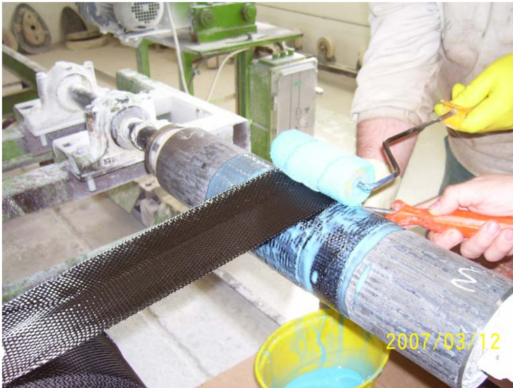
5. ábra. Egy DN 100-as csőszál külső megerősítése: karbon szövettel történő tekerés a körvarraton, folyamatos gyanta felhordás mellett.
