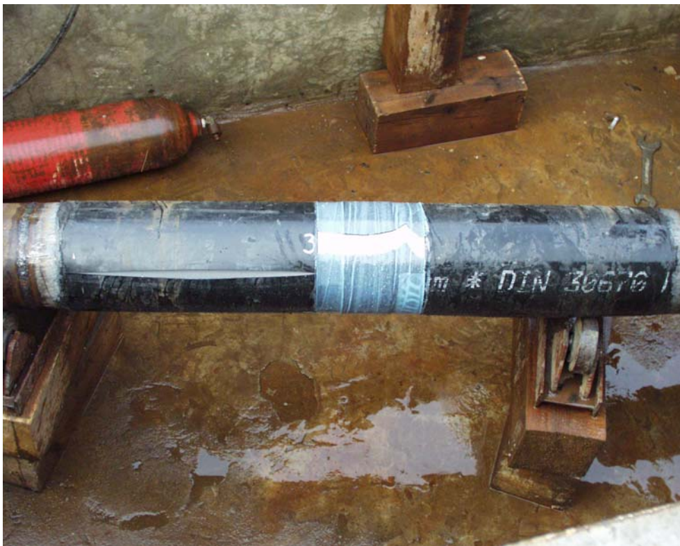
32. ábra. A DN 200-as csőszakasz (b3) felszakadt külső megerősítése a repesztővizsgálat után.
