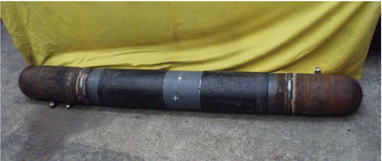
43. ábra. A megerősítés nélküli, mesterséges hibákat tartalmazó, DN 200-as csőszakasz (o1).
