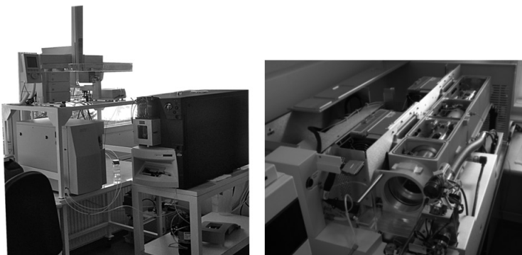
4.3. ábra. Tömegspektrométer képe működés közben, ill. szétszerelt állapotban
