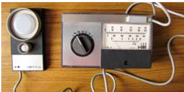
Kézi fénymérő (luxmérő)
