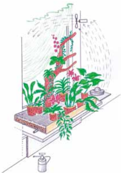
A szobai párologtató légnedvességét az üvegfelület felé irányított kis ventillátor magához szívja, a növényekre fújja, miközben az üveg mögötti meleg, száraz levegőt szétoszlatja
