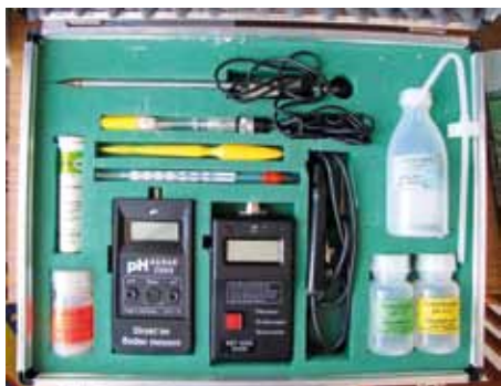
Kézi gyors talajvizsgáló készlet pH, EC és talajhőmérséklet mérésére
