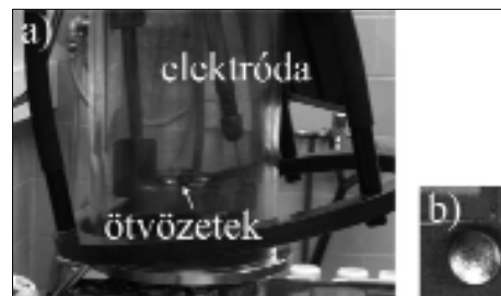
■ 1. ábra. a) Ívfényes olvasztó berendezés; b) a mesterötvözet képe
