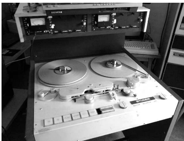
1. ábra. A felvételek digitalizálására használt Studer A80-as stúdiómagnetofon és (nagy méretű) magnetofonszalag, amelyre a Szalag Korpusz egy részét rögzítették
