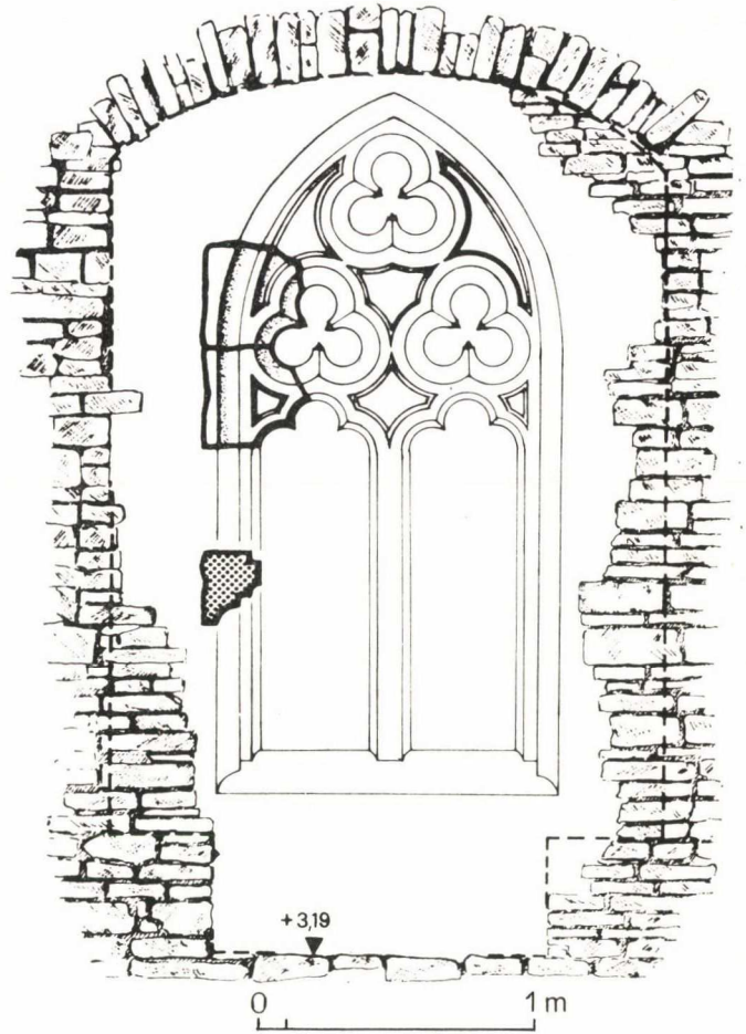
18. kép. A kőszegi palota emeletének elfalazott ülőfülkés ablaka ásatás közben
