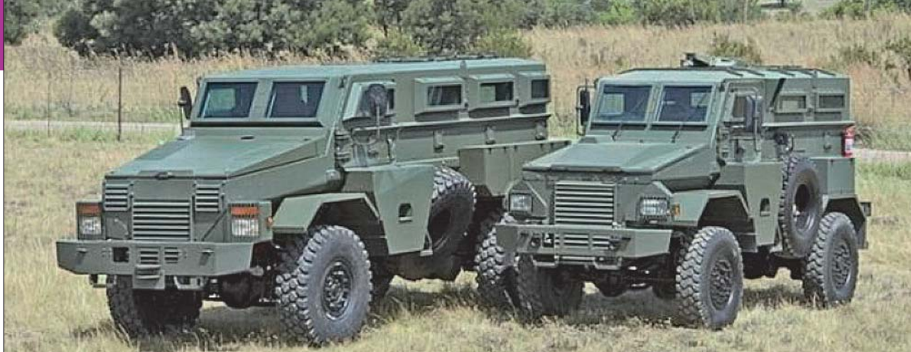
4. ábra. Egy más mellett a Puma M-26-16-os (jobbra) és nagyobb testvére, az M-36-os
