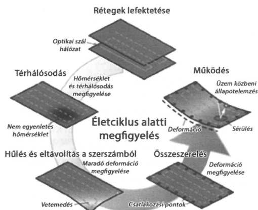
5. ábra Életciklus alatti elemzés beépített optikai szállal [15]
