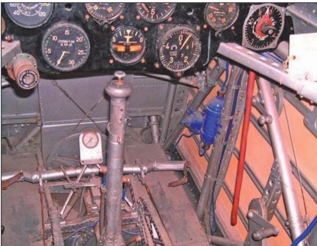
3. ábra. Múzeumi CR-32-es vadászgép kabinja. A jobb oldalon, a törzsoldal vásznazásán átút a vörös vászonzesztő lakk
