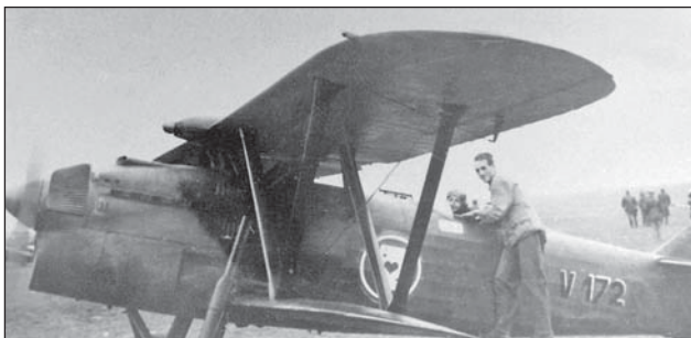
14. ábra. Az 1/5 Kör ász század gépe start előtt. A járó motor légcsvarszele a szélgenerátor légcsvarját is megpörgeti. A gépen felszegecsett adattábla található a fülke kiváltás bal oldalán. A szélgenerátor az áramvonalasan kialakított, közel cseppformájú üzemanyag kiegészítő tartály elejére volt szerelve
