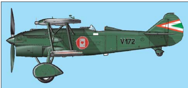
15. ábra. Az 1/5 Kör ász század V.172-es oldalszámú gépe, amely 1938 nyarán Kecskeméten együtt állomásozott a Dongó és Teve századok gépeivel. Ezen a gépen a felső szárny áramvonalas, csepp alakú középső gondolájának elejére áramfejlesztő szélgenerátor van szerelve. Magában a gondolában kiegészítő üzemanyag-tartály volt
