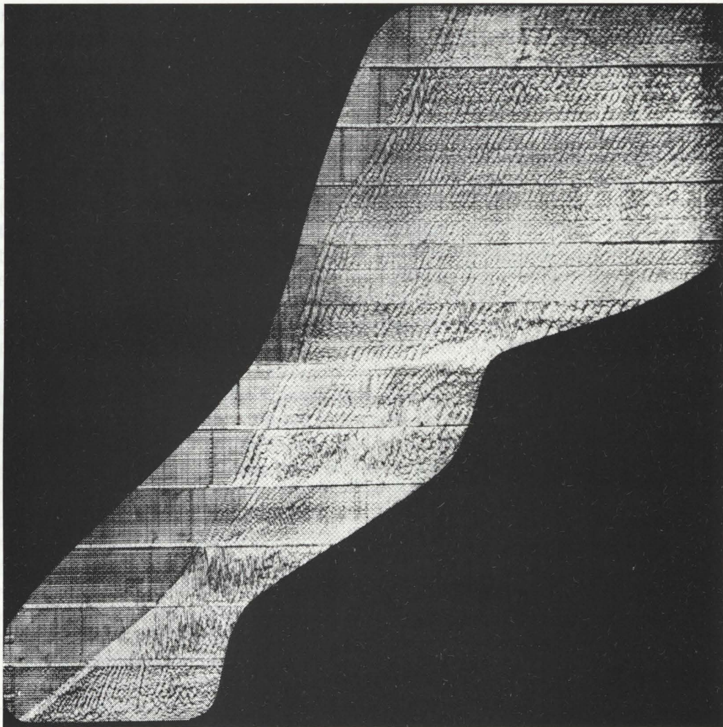
72. ábra. Szeizmogramokból kirajzolódó refrakciós menetidőgörbe a Kisalföldről. Alulról felfelé a 7-8-9-10 szeizmogramokon látható nagy sebességű hullámbeérkezések mélybeli antiklinális szerkezetet érzékeltetnek [Szénás 1960]
