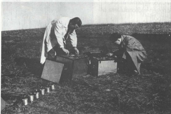
39. ábra. Az intézet laboratóriumában készült hatcsatornás szeizmikus műszer terepi kipróbálása 1952 tavaszán. Posgay Károly (fehér köpenyben) és Kovács Géza
