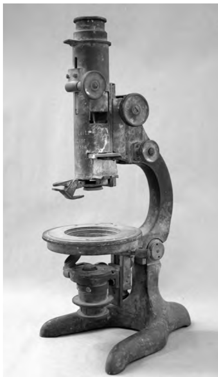
12. ábra. Megégett ásványtári mikroszkóp Fig. 12. Burnt microscope from the Mineralogical Department
