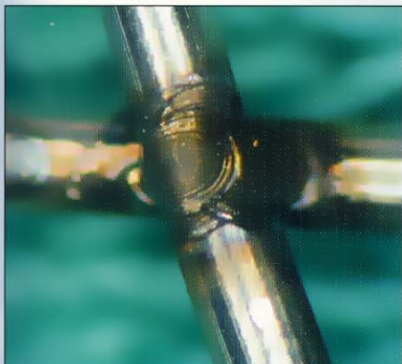
10. ábra. Nikkelhuzalok lézersugaras dudorhegesztett varrata (sztentekhez)
