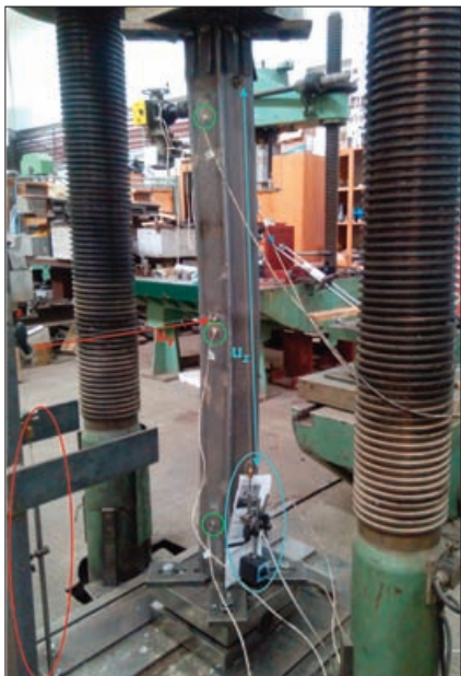
11. ábra: Kihajlási vizsgálatok kísérleti elrendezése
