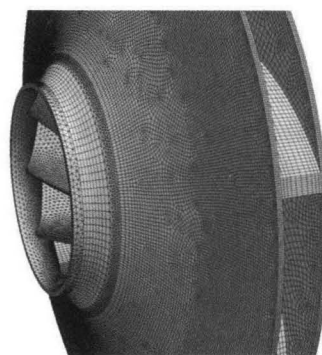
7. ábra A JK_1 jelű járókerék véges térfogatokra való felosztásának részlete
