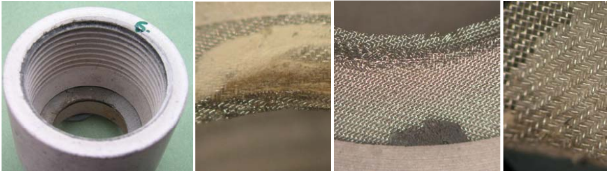
6. ábra A plazma-hegesztőpisztoly kerámia gázterelője
