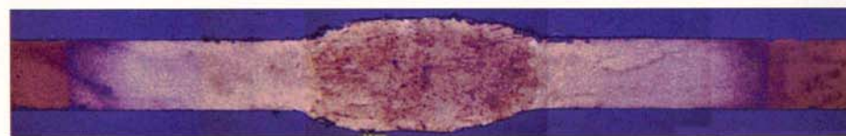
5. ábra. 12. minta metallográfiai csiszolata
