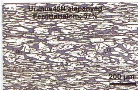
4. ábra. Az UR45N duplex acél mikroszerkezete [13]
