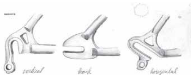
10. ábra Különböző villasaruk, a lényeg, hogy ne legyenek vékony lemezből, mert elhajlanak a nagyobb erőhatásokra. (kép forrása: Puma – Fixed gear 101) (Puma, 2009)
