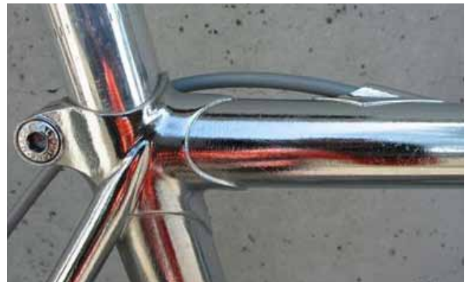
9. ábra Krómozott, hagyományos, acélcső váz, beresztelt hátsó villaszárakkal. (fotó: Bikemag)
