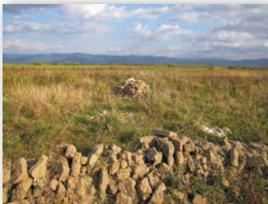
Némelyek téglavetéssel is próbálkoznak – itt épp nem sikerült megvédeni az esőtől a kivetett téglát (KI)
