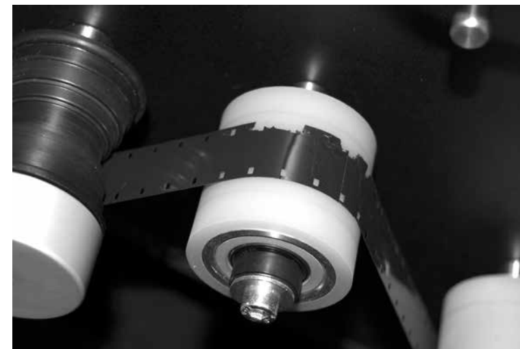
Sérült perforációjú 16 mm-es filmszalag a tisztítógörgőn
