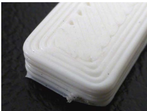
12. ábra. A gyári 4032D PLA szálból 0,5 mm rétegvastagsággal nyomtatott hajlítópórbatest felülete
