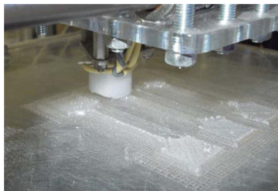
2. ábra. Politejsav szakító próbatetek nyomtatása
